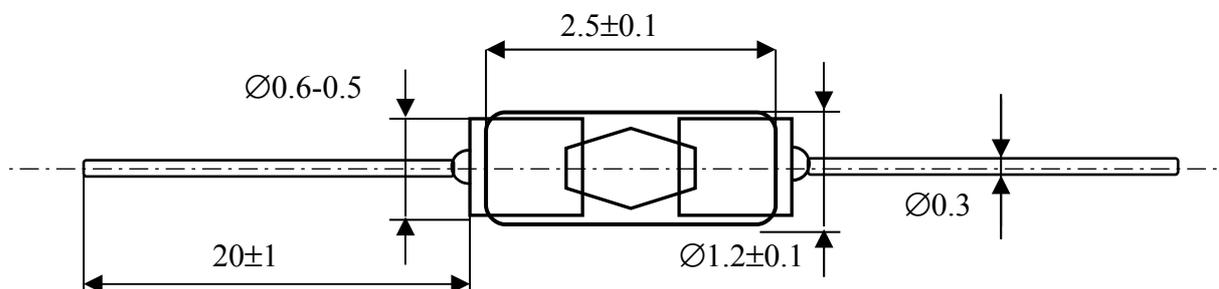
Терморезисторы марки ТРА-1 и ТРА-2 изолированные, герметизированные, с отрицательным температурным коэффициентом сопротивления предназначены для работы в электрических цепях постоянного и переменного тока для измерения температуры, скорости потока жидкости или газа, разрежения и температурной компенсации элементов электрических цепей и т.д.
